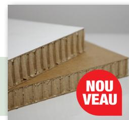
Le panneau Re-board est une alternative aux planches de bois. Sa structure brevetée permet d'obtenir un produit à la fois très léger, rigide et résistant à l'écrasement (72kg/cm<sup>2</sup>). Sa surface lisse convient parfaitement à l'impression directe, et sa solidité permet de réaliser des structures 2D et 3D.
