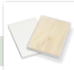
Panneau ultra léger composé d'une âme en polystyrène extrudé (XPS) combiné à un contreplaqué 100% bois de peuplier. Ce produit est idéal pour la peinture, être stratifié, filmé, sérigraphié ou imprimé numériquement. Il est extrêmement léger (227 kg/m<sup>3</sup>), et isolant thermique et phonique.
