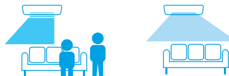
Flux d'air dirigé à l'écart des occupants
