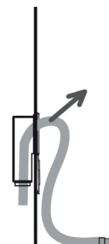
Installation de la prise à hauteur de prise de courant
