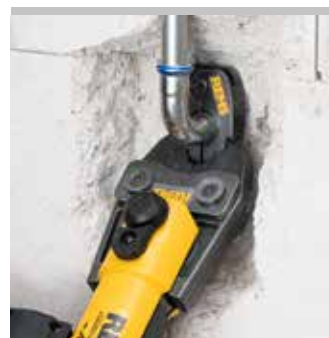
Boucle de sertissage REMS 45° (PR-2B) Brevet EP 2 774 725
