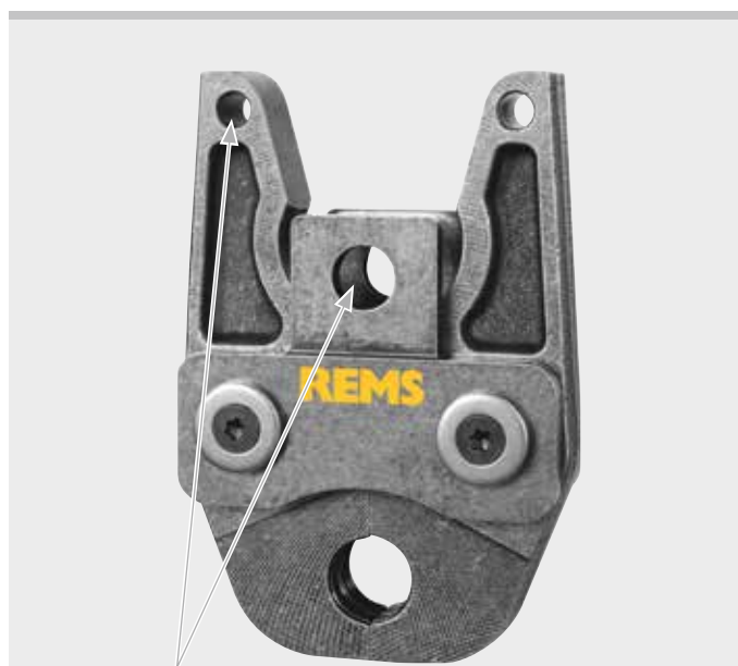
Deux dispositifs de raccordement pour sertisseuse manuelle REMS Eco-Press et sertisseuses radiales REMS 32 kN.
