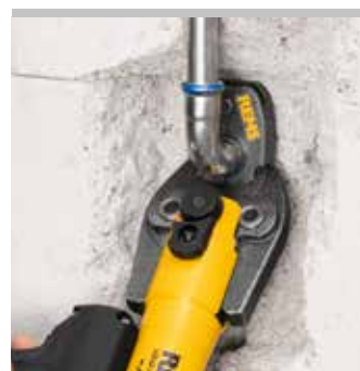
Boucle de sertissage REMS 45° (PR-2B) Brevet EP 2 774 725
