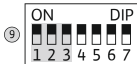
Fig. 19: Interrupteur DIP 2 : surveillance des paramètres de fonctionnement
