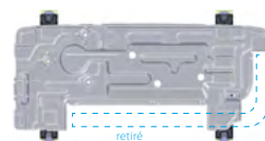
Le nouveau cadre inférieur évacue l'eau directement au sol.
