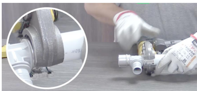
Le raccord doit comporter des douilles pour permettre le sertissage
