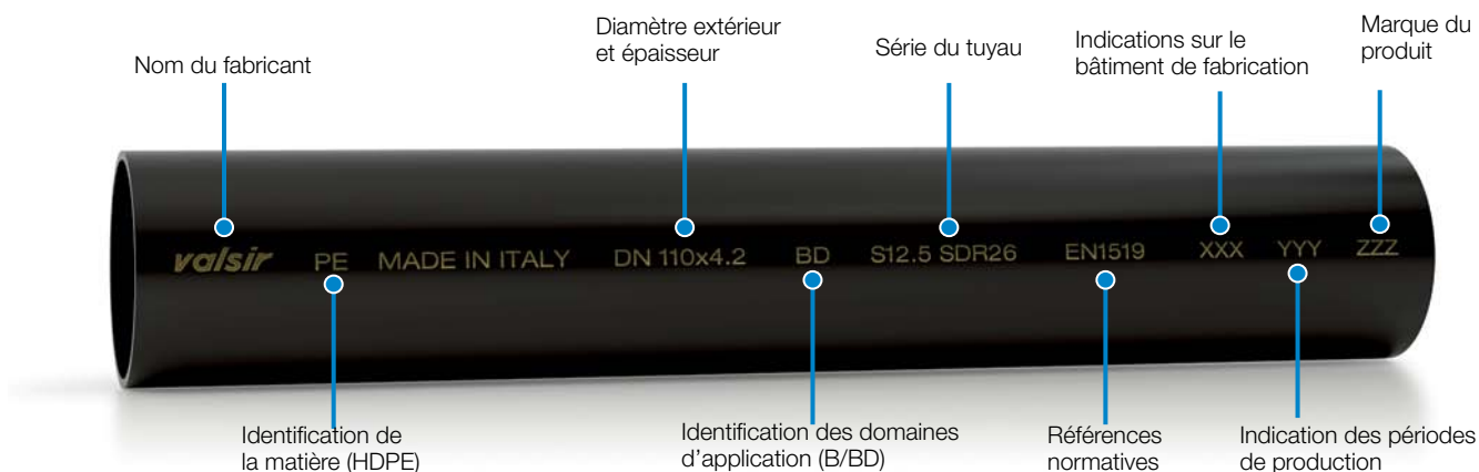
Figure Marquage des tubes.
